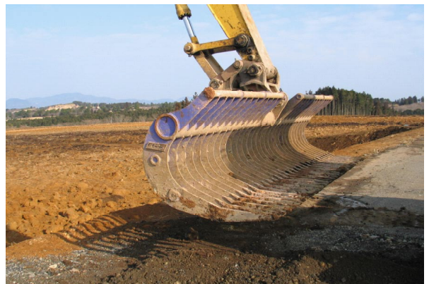
写真No.2 石礫除去機を専門メーカーに特注
